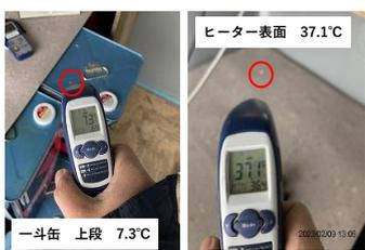
図-21 赤外線温度計測定結果
