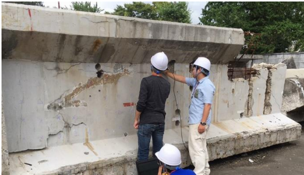
図-11 切り出しPC桁供試体
