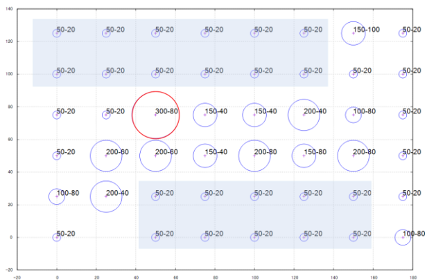
図-5 欠陥種類 直径(mm)-深さ(mm)
