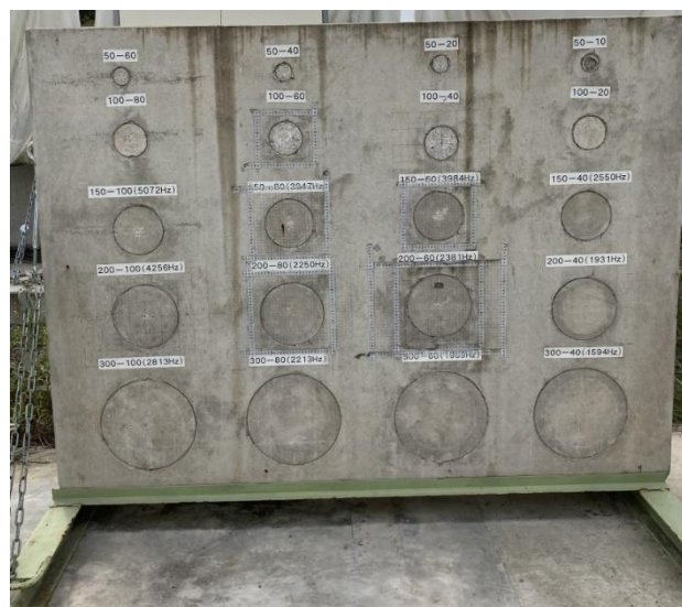
図-1 欠陥模擬試験体
