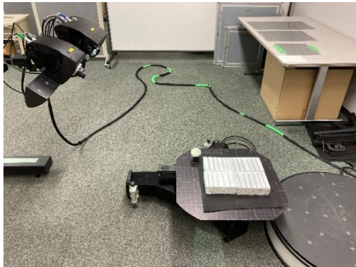
写真-2 3D デジタイザによるはつり形状測定状況
