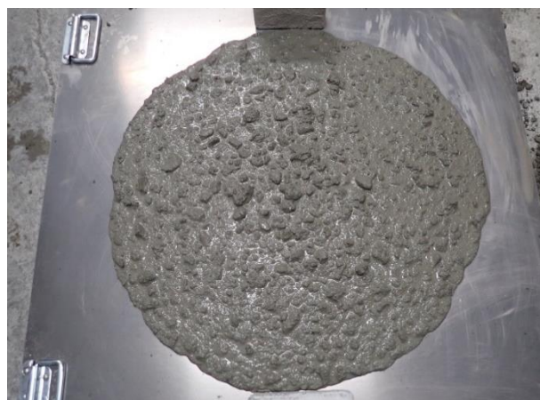
写真-1 自己充填コンクリートの性状
