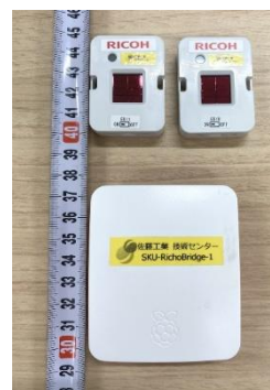
写真-5 太陽電池搭載型センサーとブリッジ機
