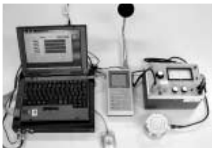
振動・騒音モニタリングシステム
