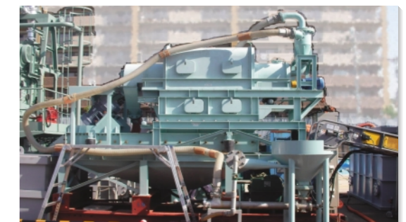
SKオンサイト土壌浄化プラント
